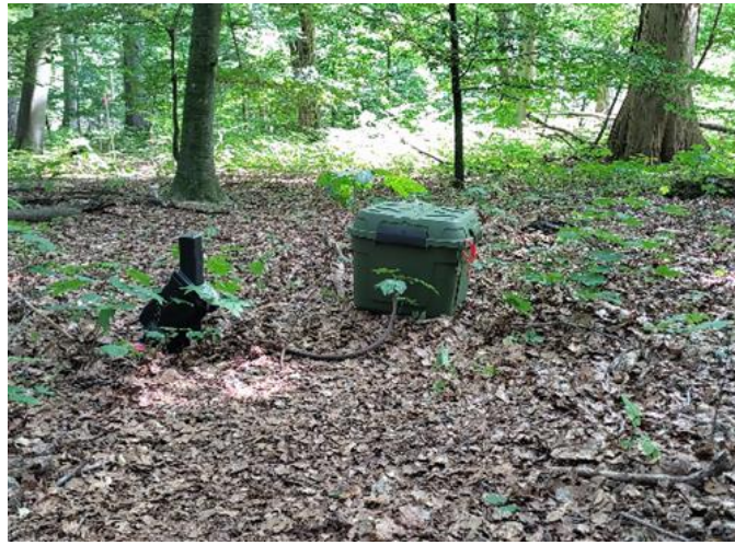
Abb. 3: Installiertes Minirhizotron mit Batterie im Buchenwald bei Eldena
