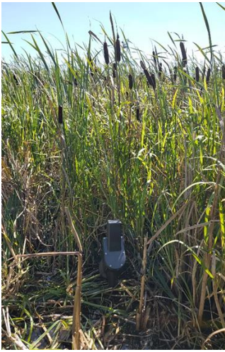
Abb. 2: Kopf eines installierten Minirhizotrons im Moor bei Dargun
